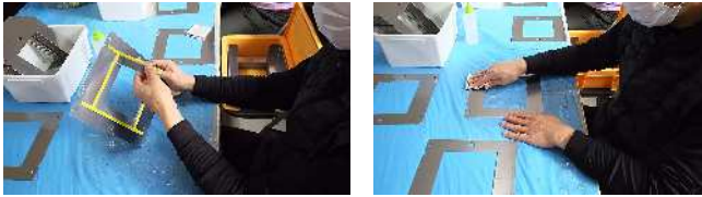
鉄板のテープはがし、拭き上げ作業
