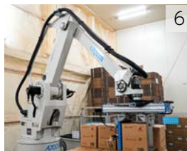
▲製品のパレット積みはロボット
