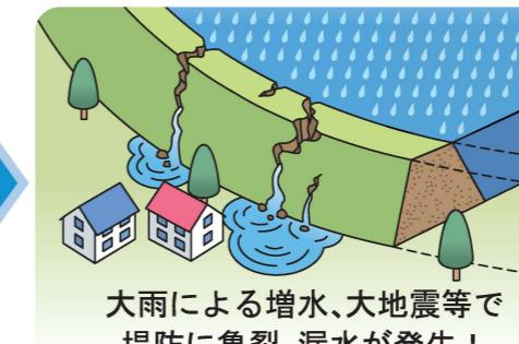
大雨による増水、大地震等で堤防に亀裂、漏水が発生！
