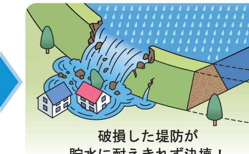
破損した堤防が貯水に耐えきれず決壟！
