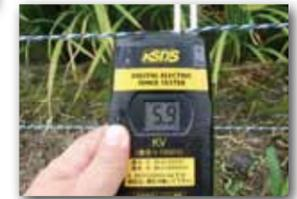
▲電圧テスターで確認。写真は5,900Vの電圧が表示されています
