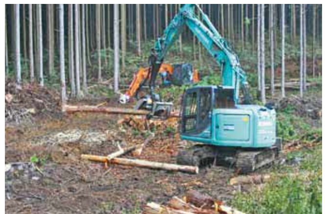
造材機械(プロセッサ)平成29年度購入：木材の枝払い、測尺・玉切りを連続して行い、集積作業を一貫して行う自走式機械
