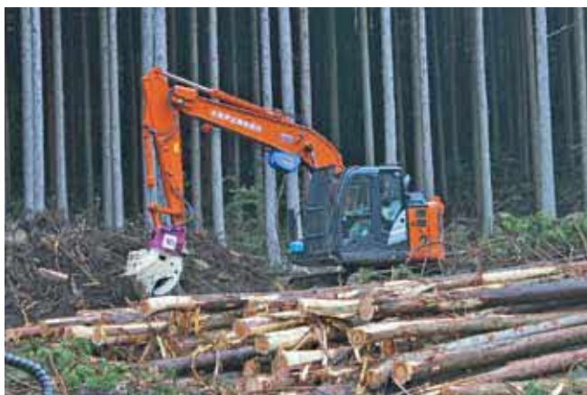
施業機械(フェラーバンチャ)令和4年度購入：立木の伐倒作業及び路網開設(掘削)、グラブ作業(掴む、集積)を1台で行うことができる。
