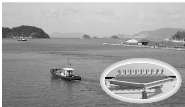
海底耕運機による作業中（佐敷川河口）
