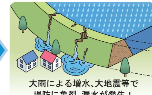
大雨による増水、大地震等で堤防に亀裂、漏水が発生！
