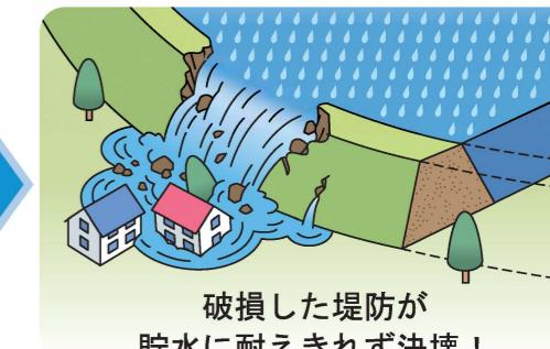
破損した堤防が貯水に耐えきれず決壟！
